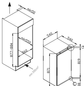
Einbau-Vollraum-Kühlschrank, 880 mm
